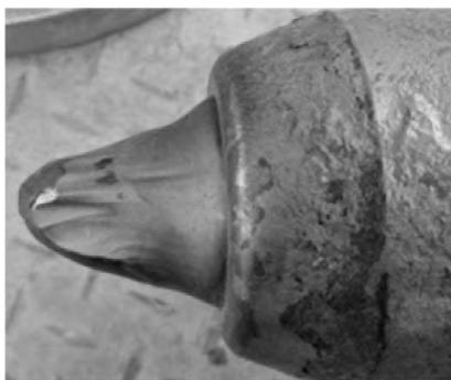
图4 黑水阀阀芯磨损失效图片
